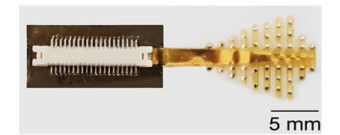
d. Montage of HD-EEG array
